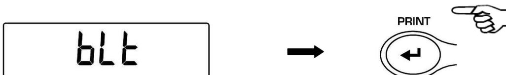
2. Puis, en appuyant sur la touche **MENU** ou **CAL**, il est possible de faire défiler les différents modes de fonctionnement de la rétro-illumination en avant ou en arrière, sélectionnez le niveau désiré et appuyez sur **PRINT** pour confirmer.
