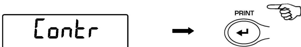
2. En pressant la touche **MENU** ou **CAL** il sera possible d'augmenter ou de diminuer le niveau de contraste de l'afficheur, sélectionner celui désiré et confirmer avec la touche **PRINT**
