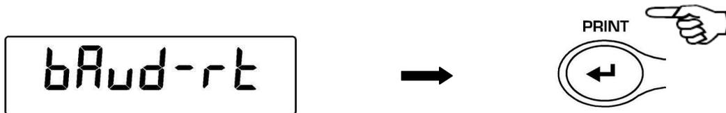
2. Sélectionnez la vitesse de transmission des données sérielles (1200-2400-4800-9600 baud). En appuyant sur la touche **MENU** ou **CAL**, il est possible de faire défiler les différentes vitesses de transmission en avant et en arrière, confirmez votre choix en appuyant sur la touche **PRINT**.
